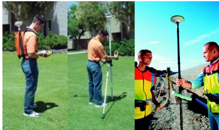
Gambar 8.7 Receiver Tipe Pemetaan
